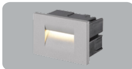
NSL1121A - Đèn LED gắn âm tường chiếu chân 67lm - Ánh sáng vàng 3000K Công suất 3.6W Dài 125mm x cao 125mm x rộng 140mm Kích thước lỗ khoét: 100x65x57mm Chất liệu : nhôm
